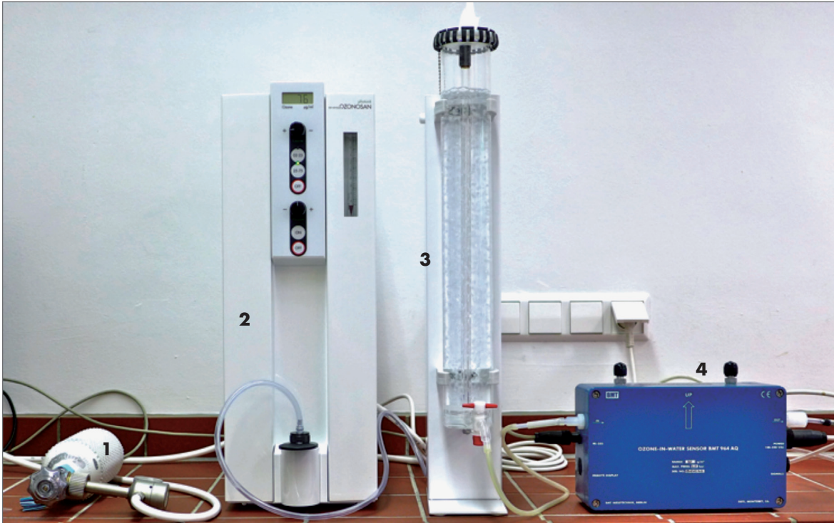
Abbildung 17. Ozoniertes Wasser, Messanordnung OZONOSAN 1. Sauerstoff 2. Ozongenerator 3. Wassersäule 4. Konzentrationsmessgerät
